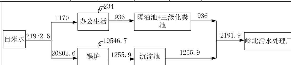
图 2-3 扩建后全厂水平衡图（单位：m<sup>3</sup>/a）
